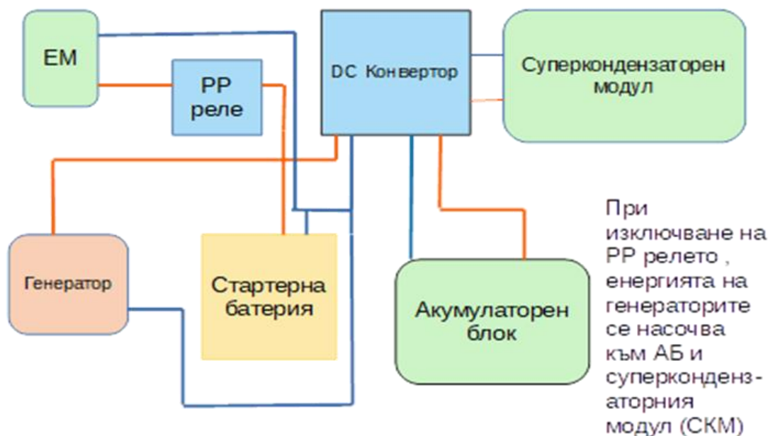
Фиг. 2. Схема с конвертор за разпределяне на енергията между електромотора (ЕМ) и акумулаторния блок (АБ)
